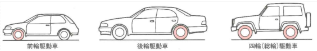
図1-5 駆動輪の位置による分類
